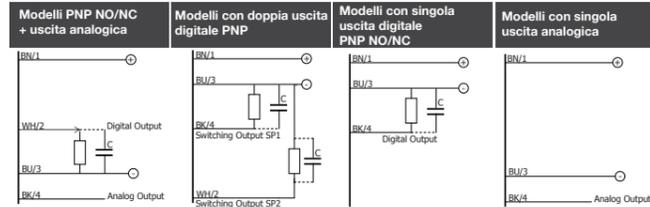
In caso di carico misto, resistivo e capacitivo, la massima capacità ammessa (C) è di 0,1 µF per tensione e corrente di uscita massime.
